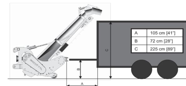
La macchina viene fornita senza carrello di raccolta. Per l'aggancio di un carrello vi consigliamo di verificare se le dimensioni sono idonee.
